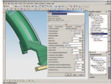
Dem Benutzer stehen sämtliche Umgebungen zur Verfügung. Der Import und Export von FEA-Daten wird jedoch über ein optionales Zusatz-Modul für „Solver“ wie Abaqus, Ansys, MSC.Nastran usw. gesteuert.
